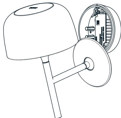
**B** Secure the electrical group to the wall. Connect to mains according to the connection chart. *Fixez le bloc d'alimentation au mur. Raccordez au réseau électrique selon le schéma de câblage.*
